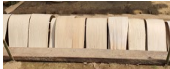
Gambar 6. Mengku Bilah Bambu. (Sumber: dokumentasi penulis)
