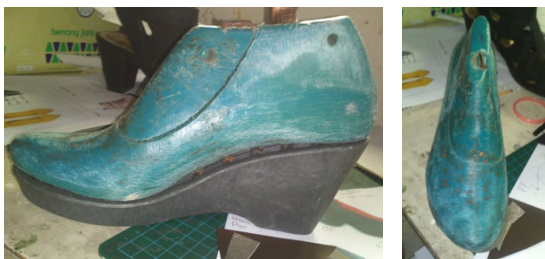
Gambar 12. Contoh Prototype master shoe last hasil verifikasi/penyempurnaan bentuk (Sumber: Dok. Pribadi)
