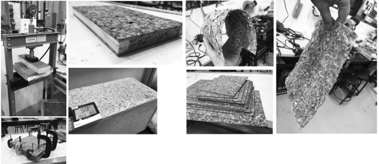
Gambar 6. Eksperimen lembar papan dan lembar kertas dari limbah tatal kayu.
