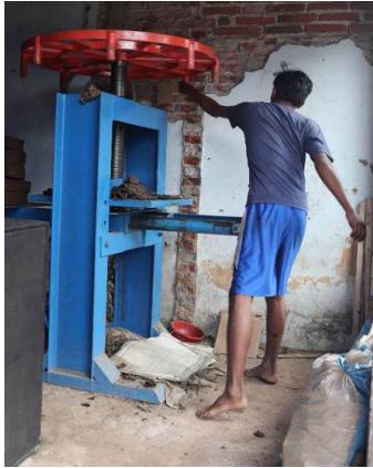
Gambar 7. Penggunaan alat teknologi press untuk produk tegel terakota (Sumber: Foto Afaf, 2020)
