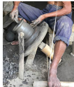
Gambar 1. Alat putar miring (Sumber: Foto Afaf, 2020)
