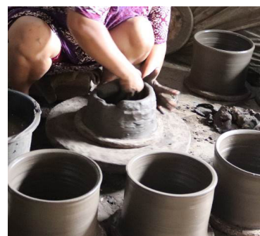
Gambar 2. Alat putar datar (Sumber: Foto Afaf, 2020)
