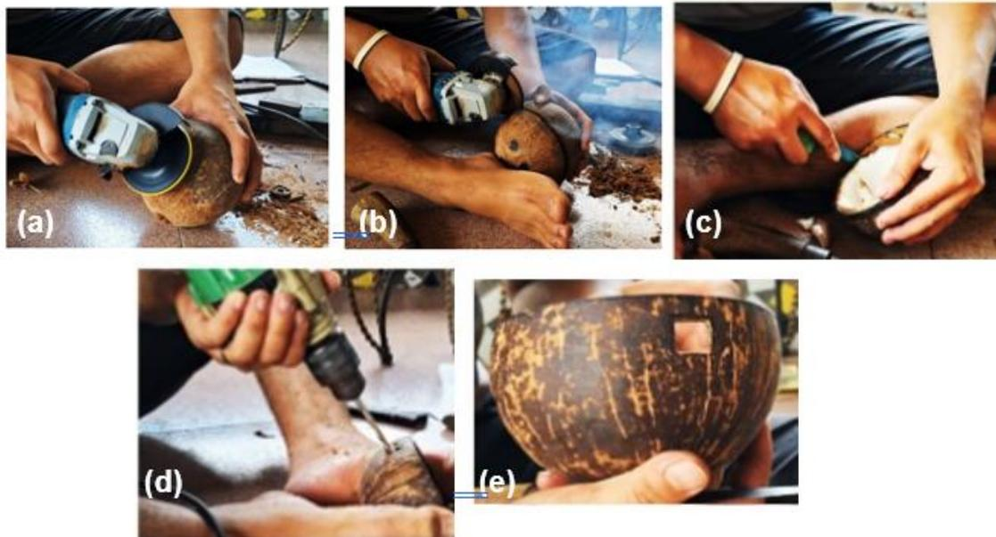
(a) Pembersihan sabut kelapa, (b) Pembelahan batok kelapa, (c) Pembersihan bagian dalam tempurung, (d) Pelubangan resonator, (e) Lubang resonator sudah jadi
